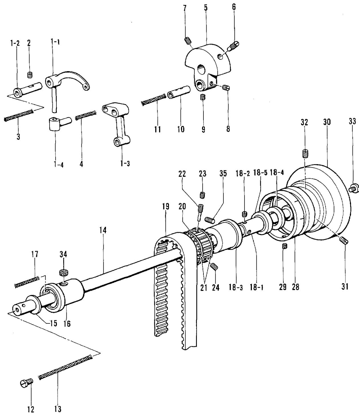
C. 上軸・天ビン関係 /Upper shaft and thread take-up mechanism/Obere Welle und Fadenabnahmeverrichtung/
