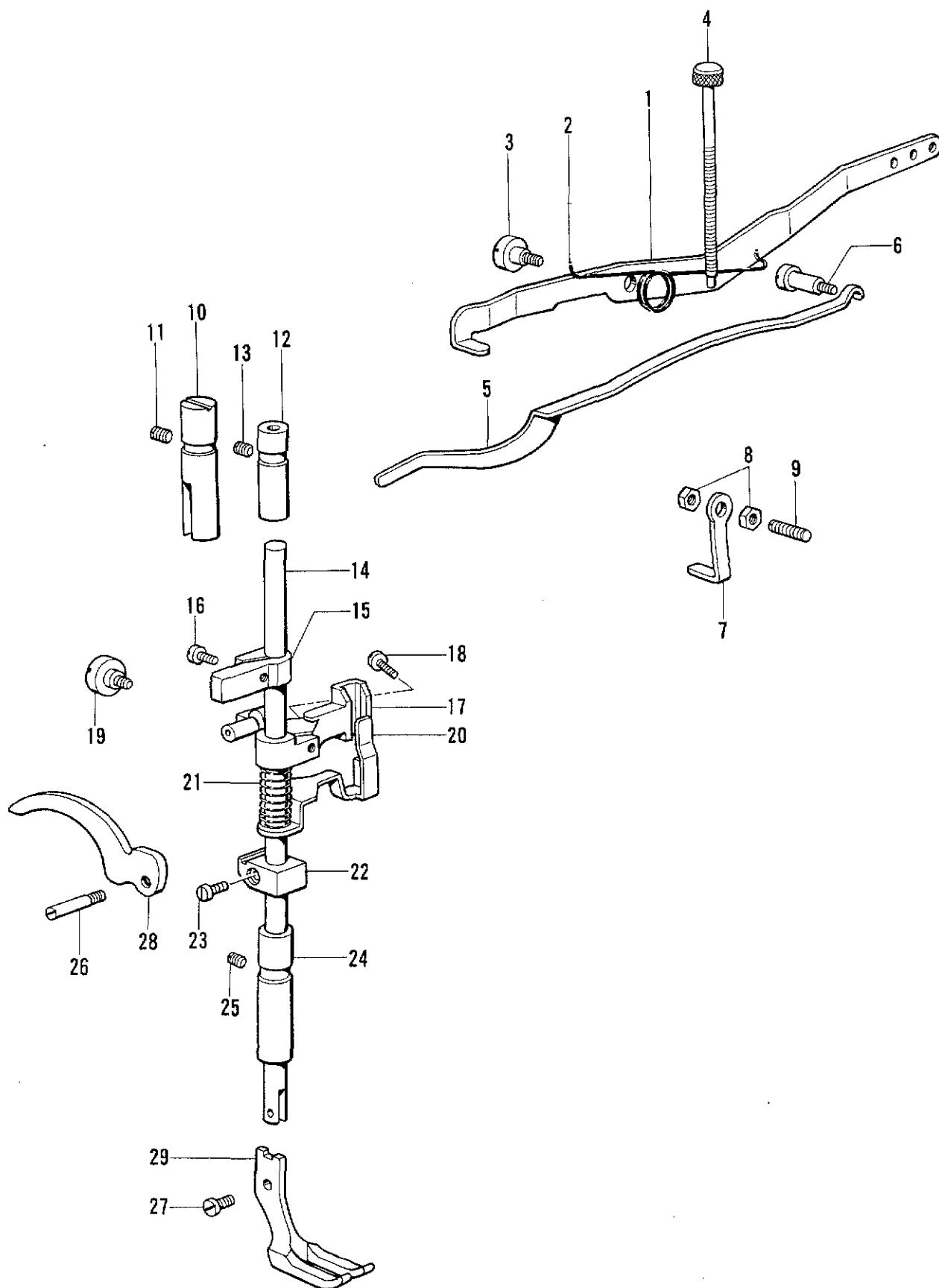
D. 押工関係 /Presser foot mechanism/Stoffdrückerfuß/
