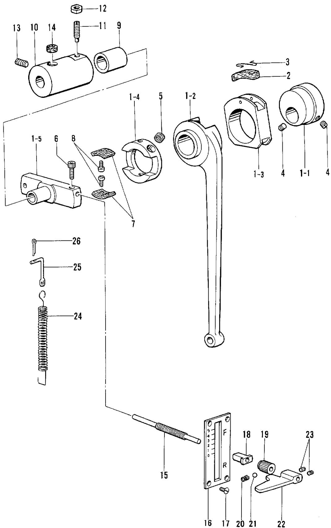
J. タッチバック関係 /Quick back mechanism/Schnellumkehrvorrichtung/
