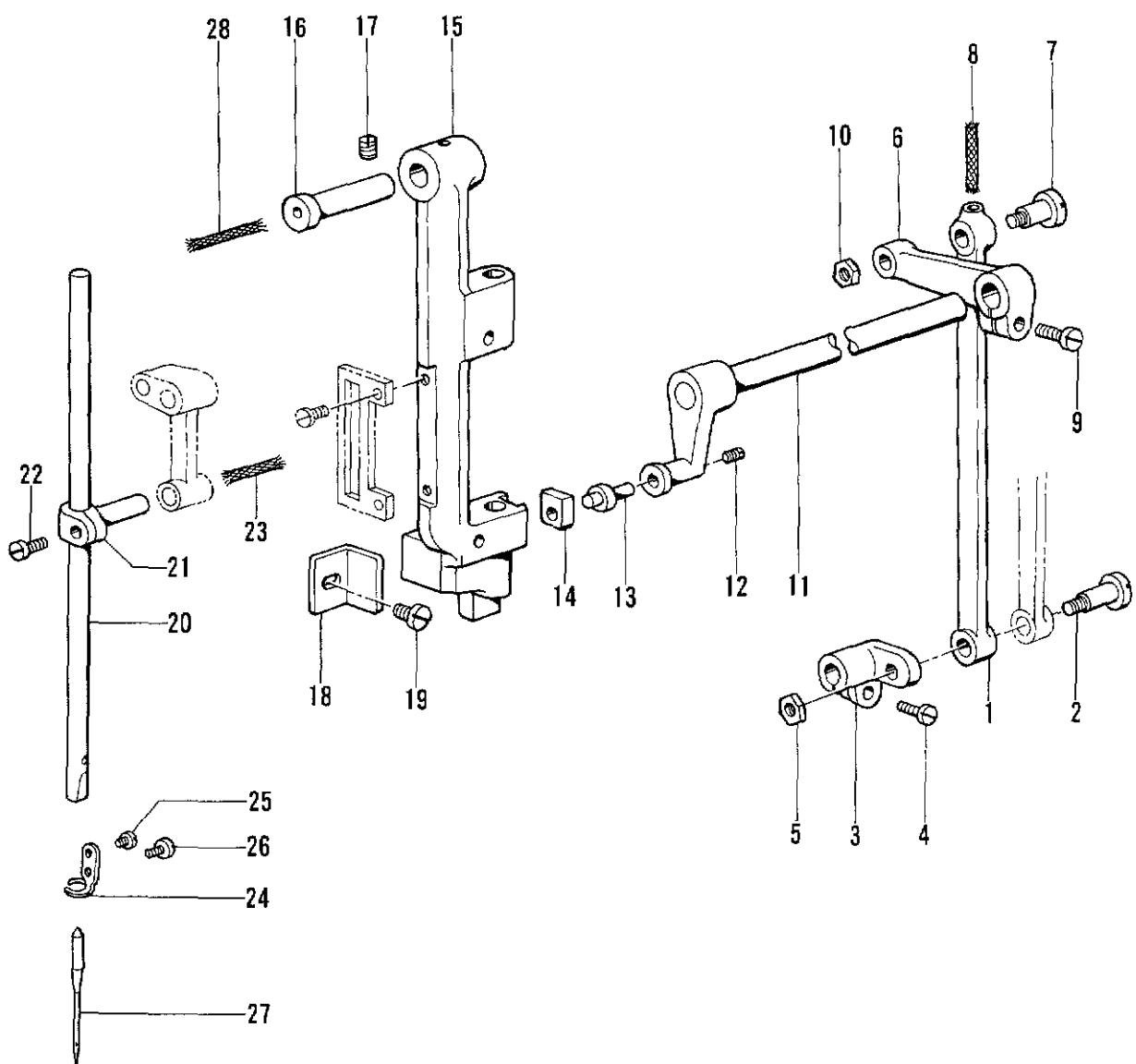
B. 針棒運動関係 /Needle bar locking mechanism/Nadelstangenbetäigung/
