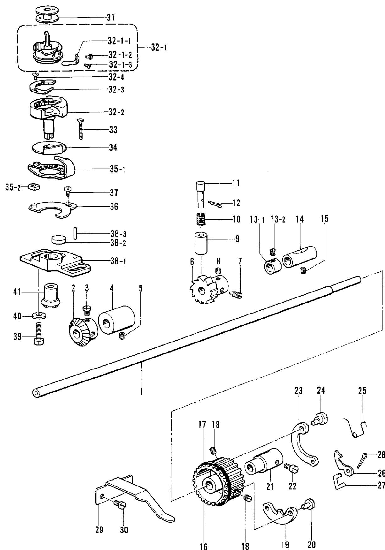
G. 下軸・カマ関係 /Lower shaft and rotary hook mechanism/Unterwelle und Greifer/
