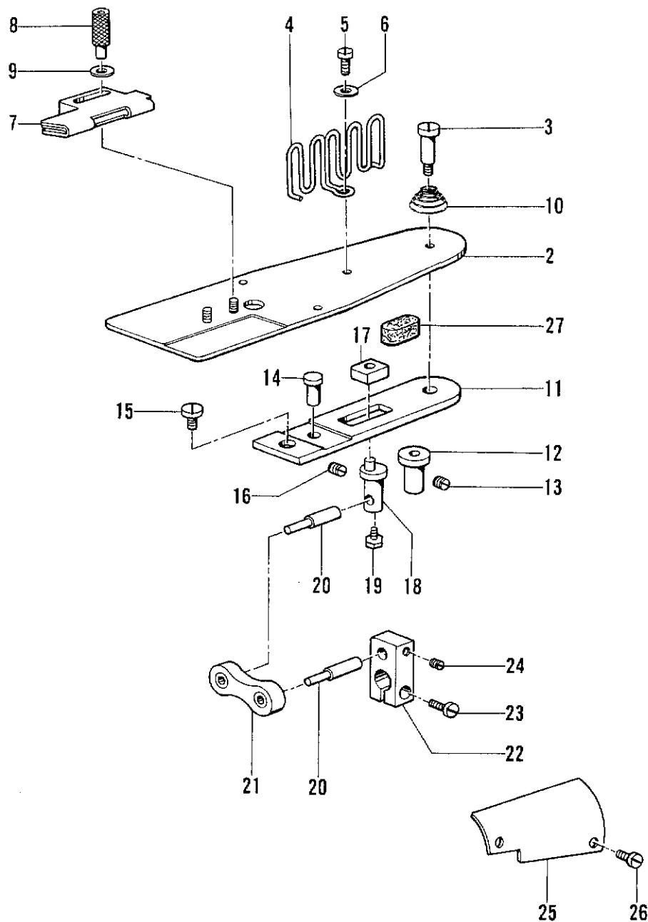
K. 同調バインダー関係 / Synchronized binder mechanism / Syncronisierte Eintaßvorrichtung /
